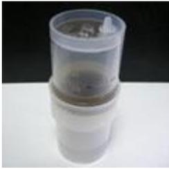
8. 上の栓を取ると、下のろ液受容器にろ過液が落ちる。
