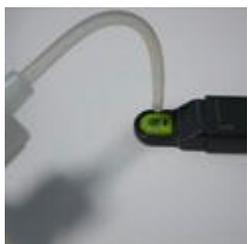
5. 導電率計のスイッチを入れ、センサー部分を純水ですすぐ。
