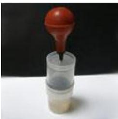
10. 目詰まりした場合や時間がない場合は、付属の加圧スポイトで脱気孔から強制的に加圧してろ過する。(それでも落ちない場合は、ろ紙だけを新しく交換してみてください)
