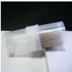
9. 目詰まりが多ろ液が落ちない場合は、震とう後直ぐに栓を抜かずに、容器ごと斜めに静置し、しばらくしてから栓を抜く。
